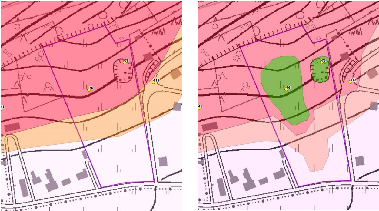
Fig. 8. Parcelle A d'Avister (pâture en zone urbanisable). A gauche, les zones de contraintes karstiques (fortes et modérées) telles que définies en 2002 ; à droite, proposition de modification sur base des observations réalisées en 2017.
